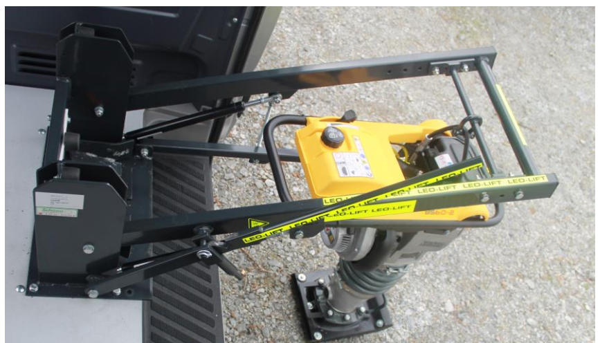
Abbildung 3: Stampfer am LEO befestigen
